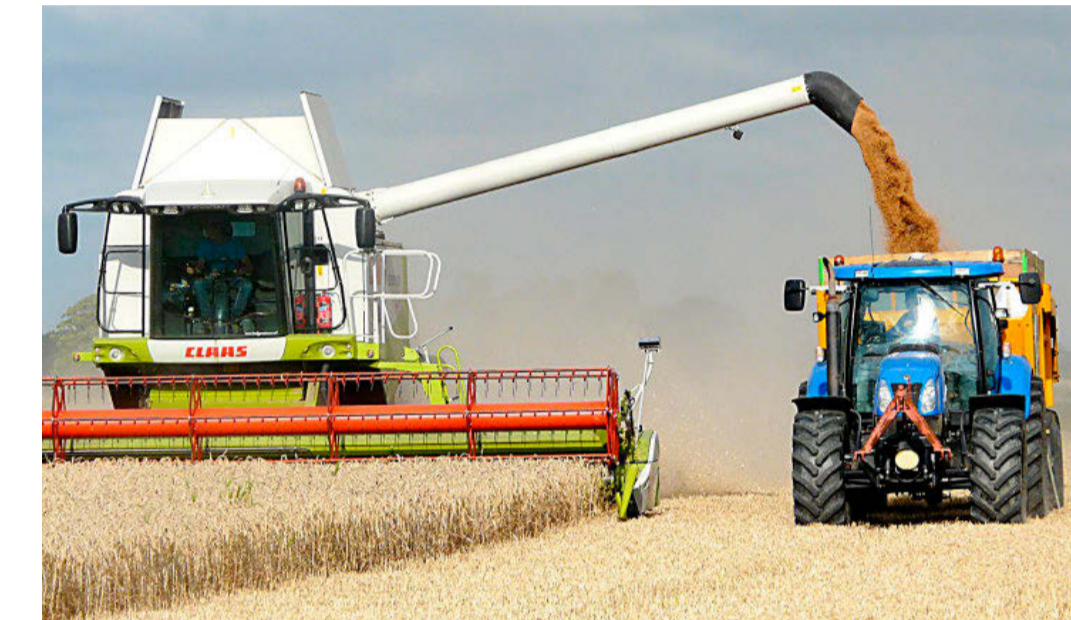
Una cosechadora corta el cereal y arroja el grano en un remolque para su almacenaje. POS / CCO
